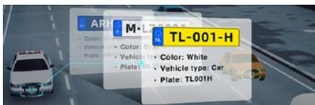
Die ISIS-MS-C2962-RELPC kann mit Full HD Auflösung und 60 Bildern pro Sekunde Kennzeichen bei Geschwindigkeiten bis 200 km/h erfassen und dabei auch die erfassten Fahrzeuge kategorisieren in: Kennzeichentyp, Kennzeichenfarbe, Fahrzeugtyp, Fahrzeugfarbe, Fahrtrichtung.
