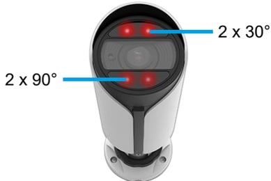
Dank der 2-Zonen Beleuchtung können Personen oder Objekte im Nahbereich sowie in entfernten Bereichen optimal ausgeleuchtet werden. Zwei LEDs sind für den Nahbereich mit breitflächiger 90 Grad Ausleuchtung. Bei einem hohen Zoomfaktor für entfernte Bereiche arbeiten die zwei LEDs mit 30 Grad für eine schmalere Ausleuchtung mit größerer Reichweite bis 50 Meter.
